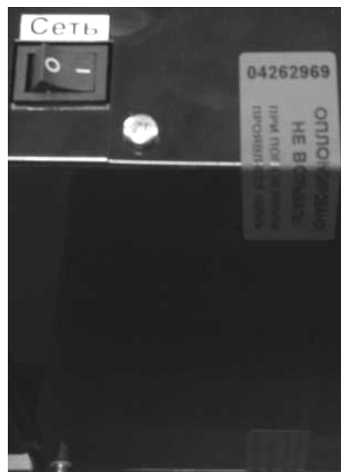
Рис.4. Пломбировка корпуса блока управления
