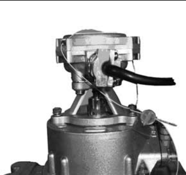
Рис.2. Пломбировка датчика расхода топлива
