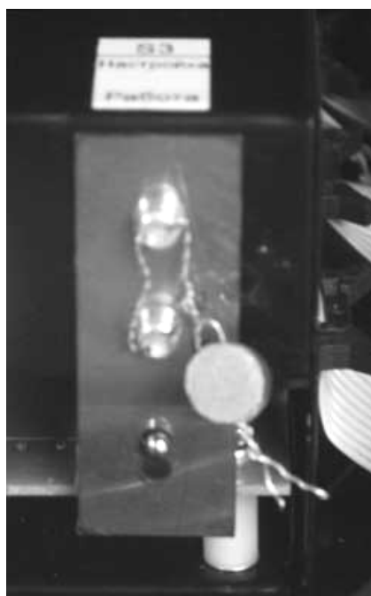
Рис.3. Пломбировка тумблера «Настройка/Работа» блока управления
